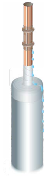
B4.1.1a Tejping mot rör och isolering.
