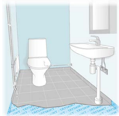
B4.6.2a Rör genomföring i golv i WC-rum.
