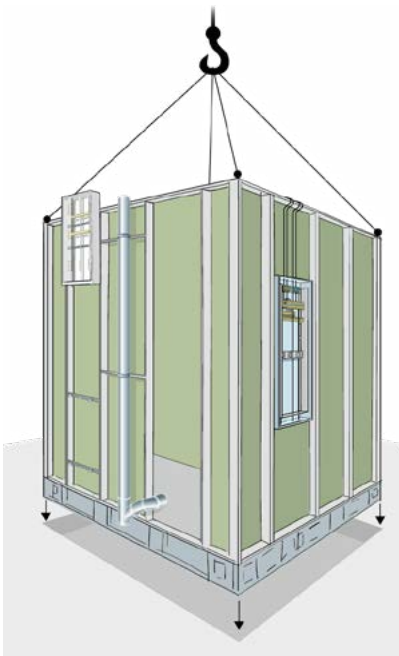
B7.2.4a Prefabricerad våtrumsmodul.
