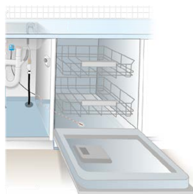
4.3.1a Exempel på diskmaskin med läckagebrytare och lätt åtkomlig manöveranordning.
