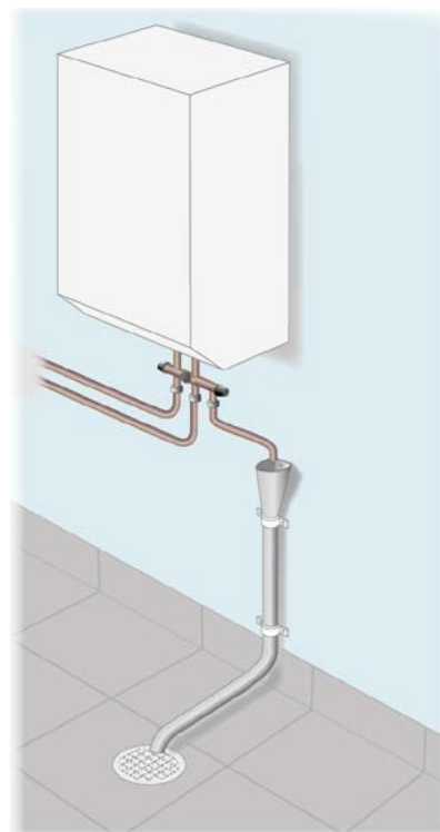
4.4.7a Spilledning från säkerhetsventil.
