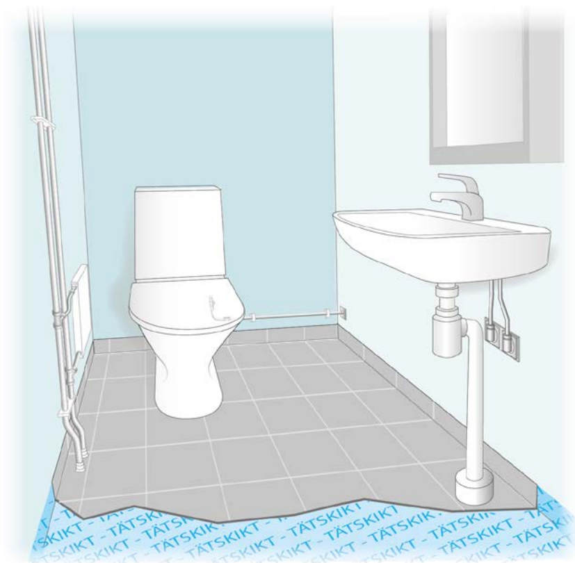
4.6.2a Rör genomföring i golv i WC-rum.
