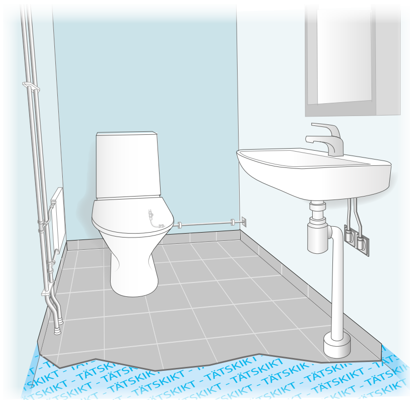
4.6.2a Rör genomföring i golv i WC-rum.
