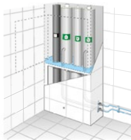
4.1b Prefabricerad konstruktion, schaktbotten.
