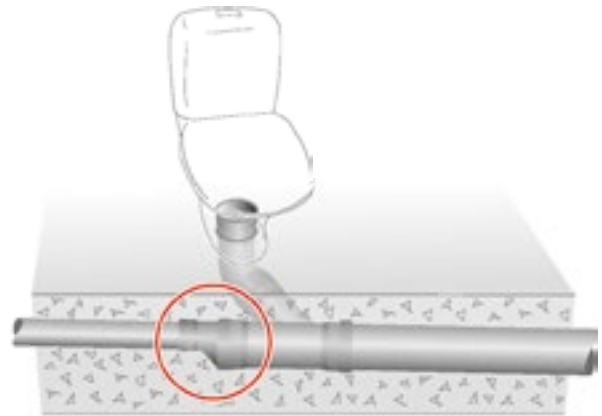
4.4.1c Dimensionsförändring av spillvattenledning.
