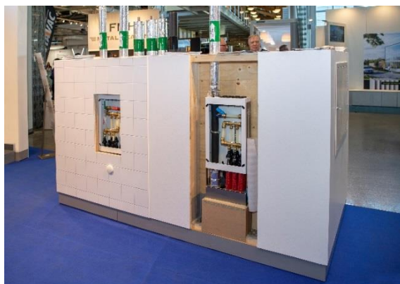
Separat stamfördelarskåp på Nordbygg 2018
