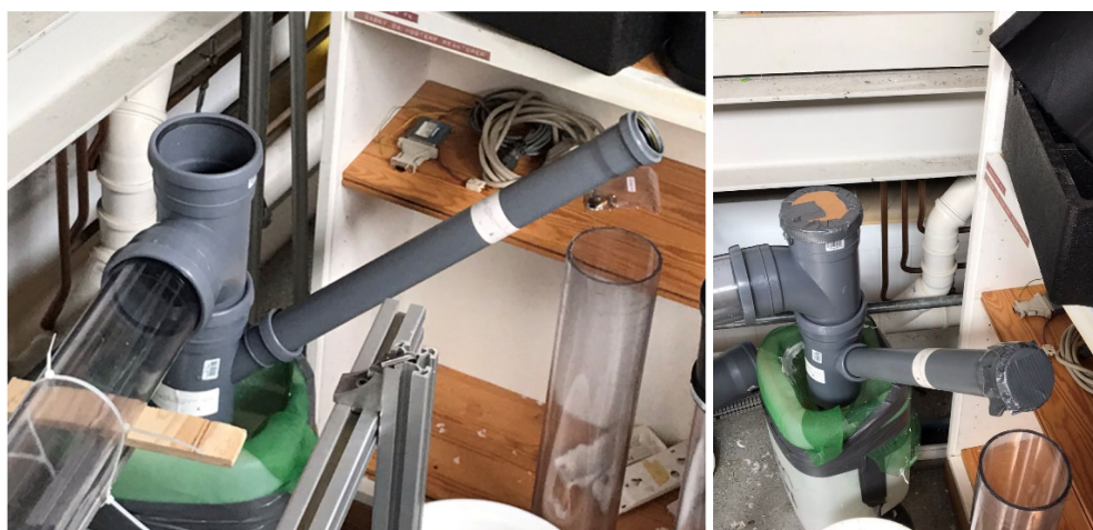
Figur 10: Emulering av begränsning av luftning.
