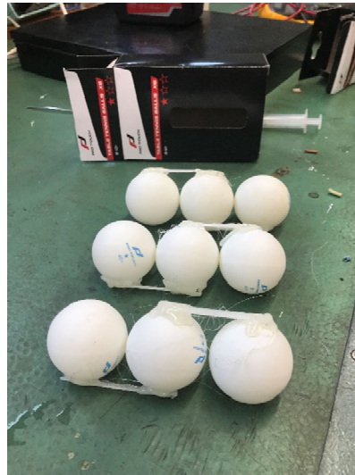
Figur 1: Testfekalie för provning av spolförmåga, utformning enligt Cambell 3 .
